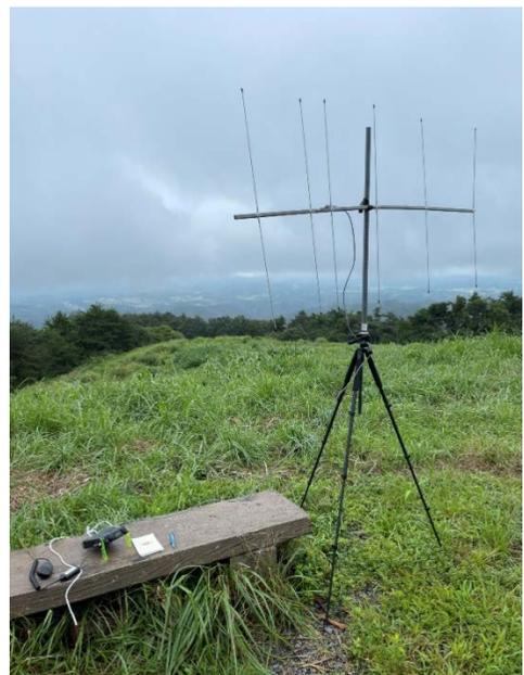
図4 2mバンド用6エレYagi 近くの山で運用。FT817ND使用。福島から1エリア向け。神奈川県までQSO可能でした。50Wでも使用可能です。
