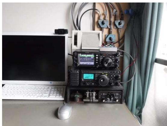
最後に天谷医院の病室を改造した研究室(無線部屋?)の写真です。リグは FT-897 を使用しています。上の FT-991 は C4FM WIRES-X 用で、パソコンには最近始めたリモートミーティング用の WEB カメラが付いています。パドルは、カツミの古いスクイズ KEY EK-150 を使っています。こんなところから出ている MD CW NET です。皆さんのチェックインをお待ちしています。
