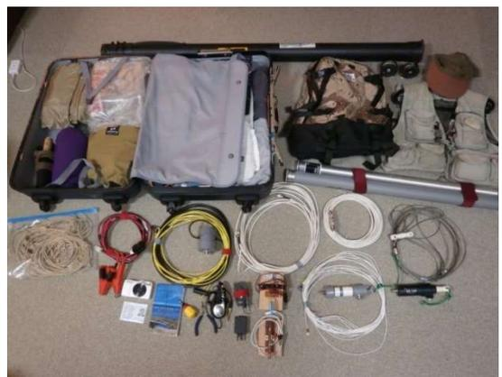
例年の釣りやキャンプ道具だけでも大荷物なのに、さらに無線設備の準備となると大変でした。当初、同軸は 5D2V を 20m 用意しましたが、余りの重さに驚きました。仕方なく同軸は 3D とし、10m を 2 本準備し、同軸ロスを考え、状況に応じて接続するようにしました。無線機以外での重量物は電鍵で、1kg 近い重量は致命的です。そこできわめて軽い木製台座のノギリ刃を使った自作複式電鍵を持って行きました。南半球の伝播状況がわからないので、一応アンテナは、4 バンド出られるように準備しました。7MHz と 21MHz は DP、10MHz と 14MHz は ZEPP アンテナ、ポールは 10m のガラスポールを用意しました。無線機は ZL は家庭用の電圧が 200V なので、変圧器不要で 200V 対応可能な FT-897 にしました。無線機をスーツケースにつめると軽く荷物重量は 20kg を超えてしまうので、手荷物として機内持
