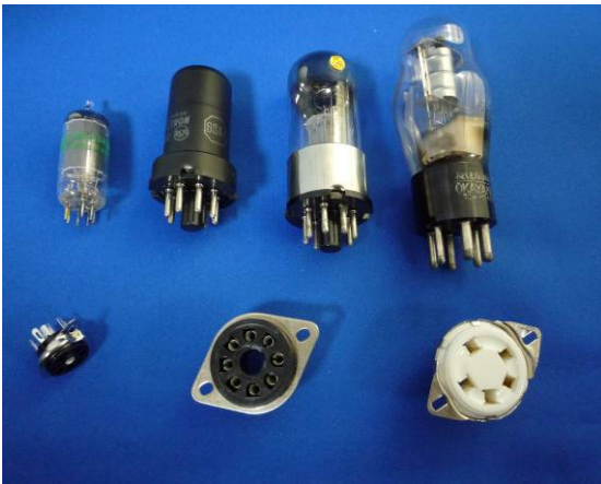
写真18:各種真空管。左から MT、メタル、GT、ST 管。下段はそのソケット。
