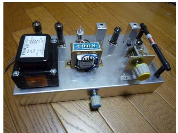
写真14: 組み立てたラジオ少年5球スーパーキット
