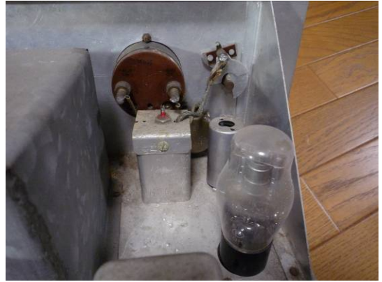
写真8: BFO コイルとピッチ調整 VC。手前には 6ZP1。
