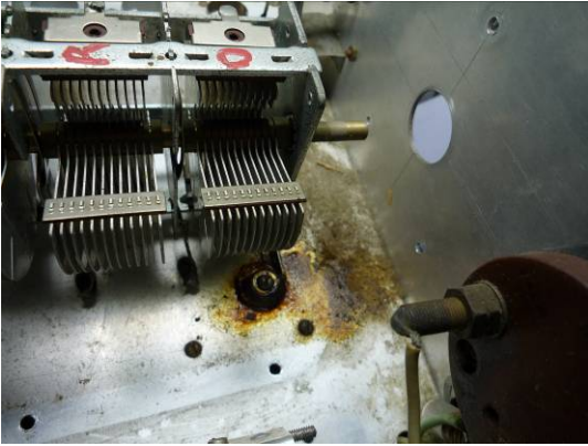
写真6: ケースを外した主選局 VC。取り付けゴムは溶けている。
