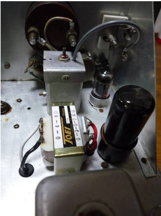
写真11: 改造した低周波増幅部。出力管 6V6 と OPT。
